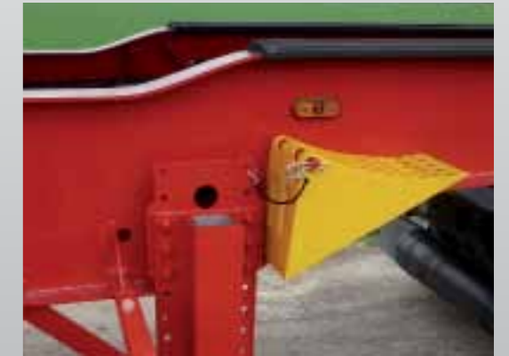
Obniżenie podwozia celem zachowania maksymalnej wysokości pojazdu 4000 mm
