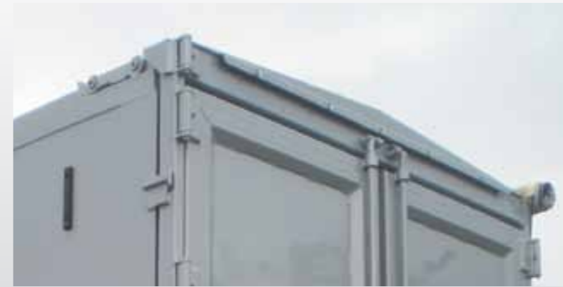
Kłapo-drzwi z uchylną górną belką ramy
