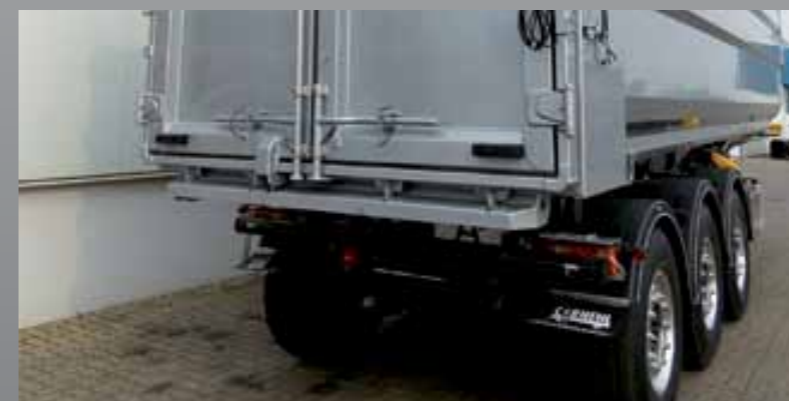
Kłapo-drzwi z uchylną górną belką ramy
